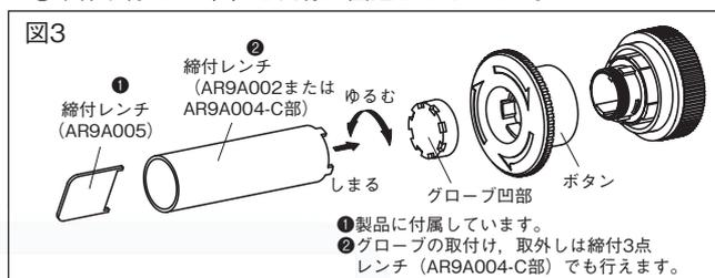
③ 下図の通り、回転筒の凸部にボタンの凹溝を合わせて挿入しグローブを挿入してから、締付レンチ (AR9A002またはAR9A005) で締付けて (右回り) ください。
