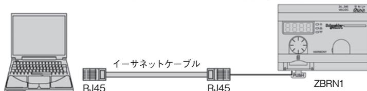
ZBRN2: アクセスポイントを下図に示すように PC と接続します。
