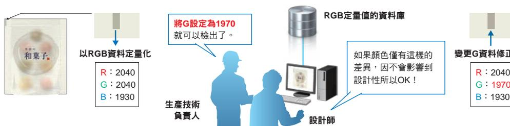
\*1. 使用IO-Link (E3S-DC) 或EtherCAT (E3NX-CA) 的RGB資料傳送功能，可以建立感測器連結至資訊網路的系統。
