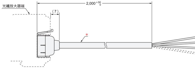
\* 導線  $\phi 4/3$  線芯數/標準2m (導體截面積:  $0.2\text{mm}^2$  (AWG24) /絕緣體直徑:  $\phi 1.1\text{mm}$ )
